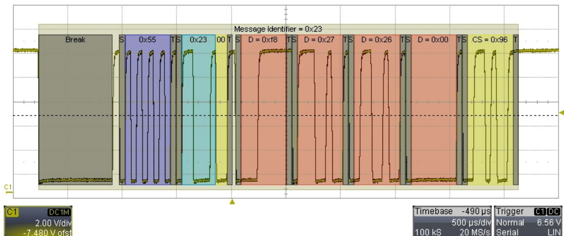
Abbildung 5.1: LIN-Frame (ID 0x23) mit vernachlässigbaren inter-byte-spaces
